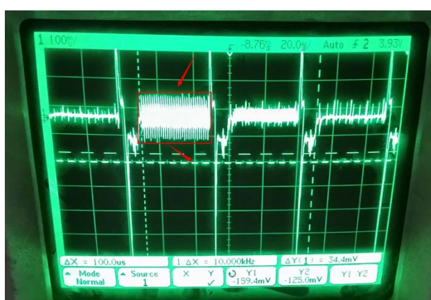
视频信号。红色方框部分为当前屏幕显示的 Y 光标线部分对应的视频信号。
