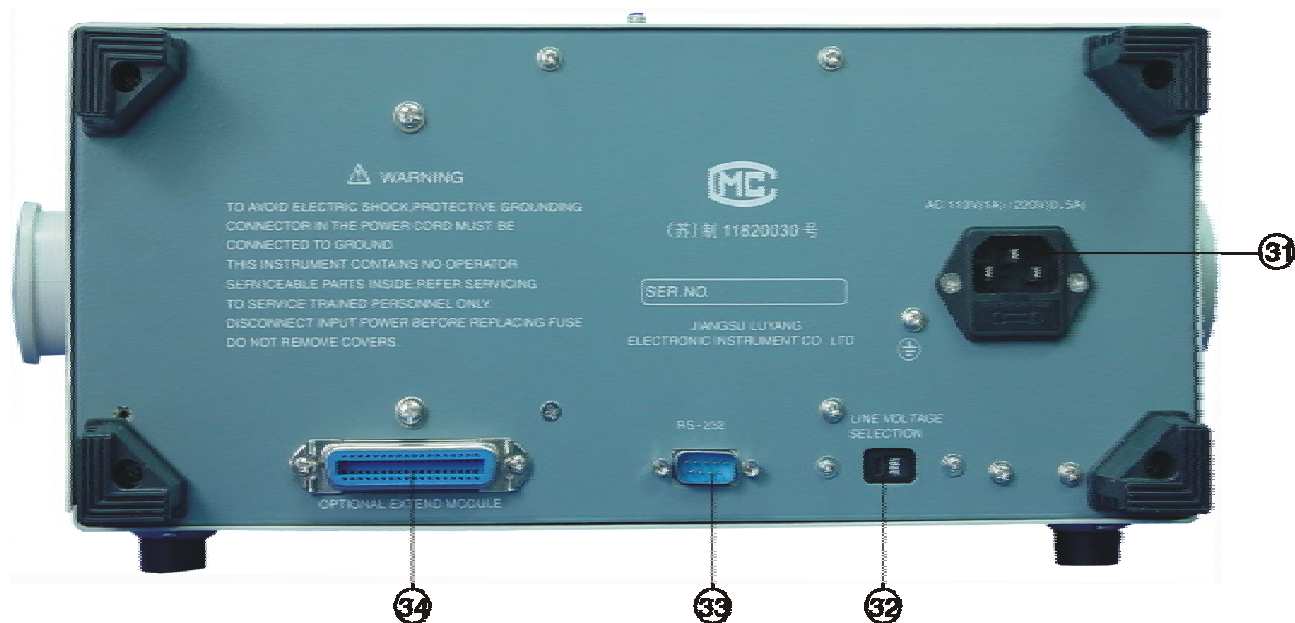
图 3-2 YB54000 系列示波器后面板
