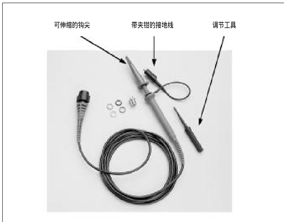
图 2-14 典型的通用电压探头及其标准附件。
