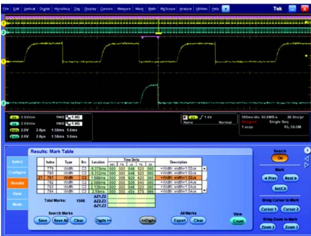
搜索步骤 2: Wave Inspector 自动搜索和记录每个事件, 用白色的空三角形标记事件。然后可以使用 Previous 和 Next 按钮, 从一个事件跳到下一个事件。
