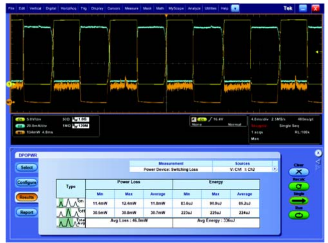
开关损耗测量。自动电源测量可以迅速准确地分析常见电源参数。
