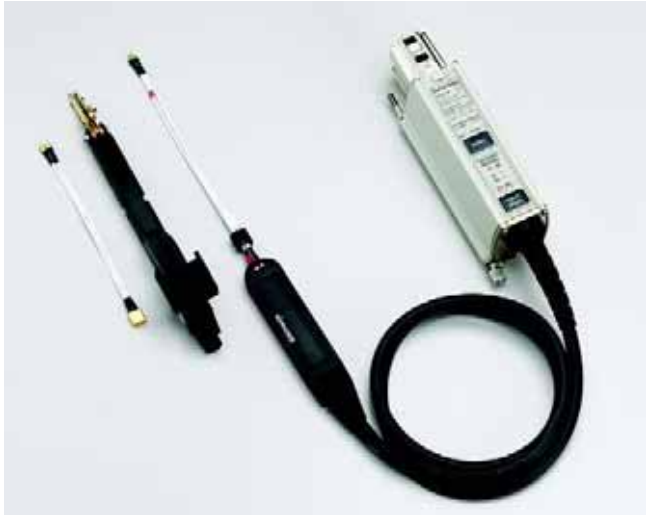
P7500 TriMode 三模探头简化了复杂的测量设置
