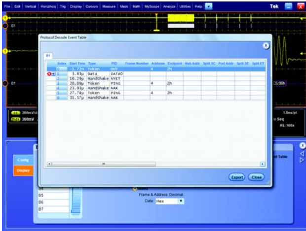
事件表显示了长采集和解码后的串行数据包数据。
