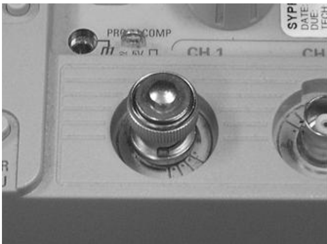
图5.7: BNC 短路电容
