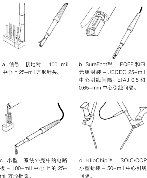
图 2.16. 小型探头使用的探头头部适配器部分实例。这些适配器可以明显容易得多地探测小型电路，通过提供信号完整性高的探头测试单点连接，可以提高测量精度。
