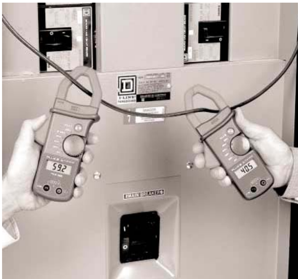
图 1 一个电流两种读数，你相信哪个？图中的回路为一个有畸变电流的非线性负载供电。真有效值卡钳式电流表（左）上的读数是正确的，而平均值卡钳式电
